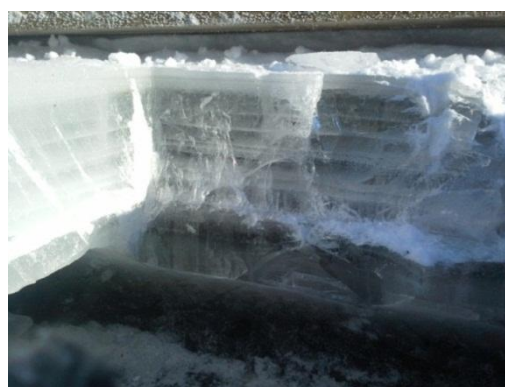
Рисунок 6 – Срез и замеры льда в бассейне при намораживании поверхностного слоя.
