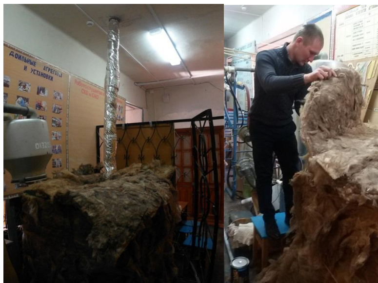
Рисунок 5 – Лабораторная установка по намораживанию льда вокруг испарителя термосифона.
