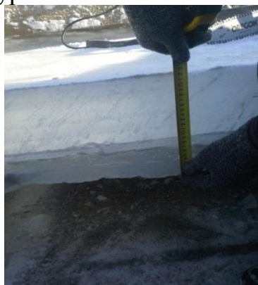
Рисунок 6 – Срез и замеры льда в бассейне при намораживании поверхностного слоя.
