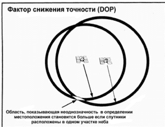
Рис. 31- Влияние геометрии созвездия GPS спутников на точность определения координат.
