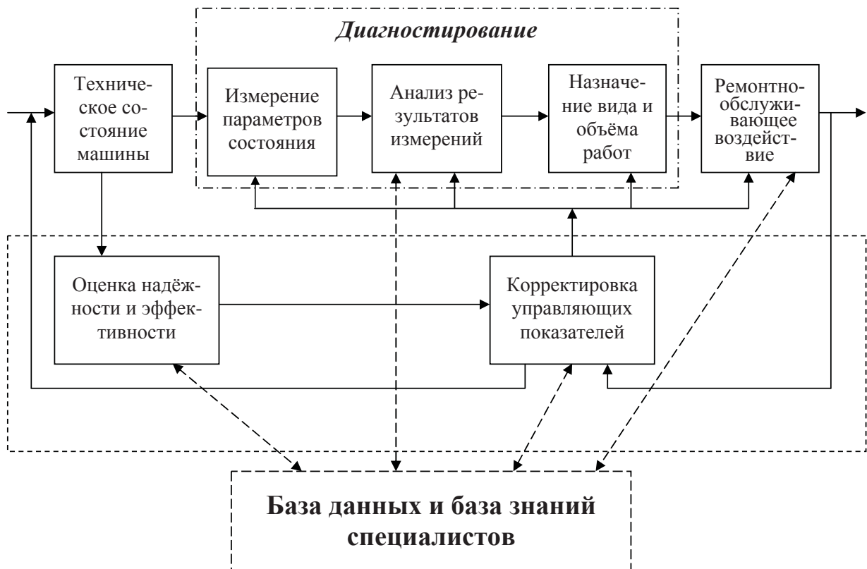
Рис. 2 – Схема управления техническим состоянием машины
