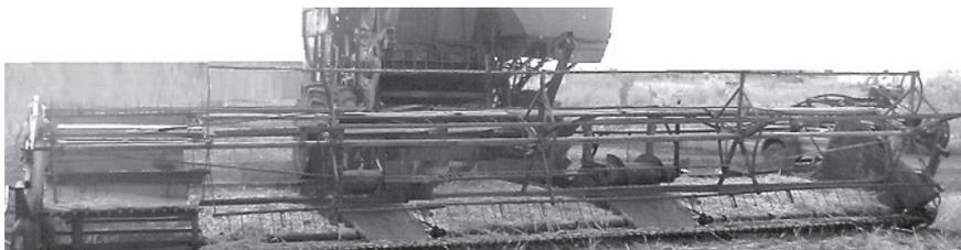
Рисунок 5 – Экспериментальный образец порционной жатки
