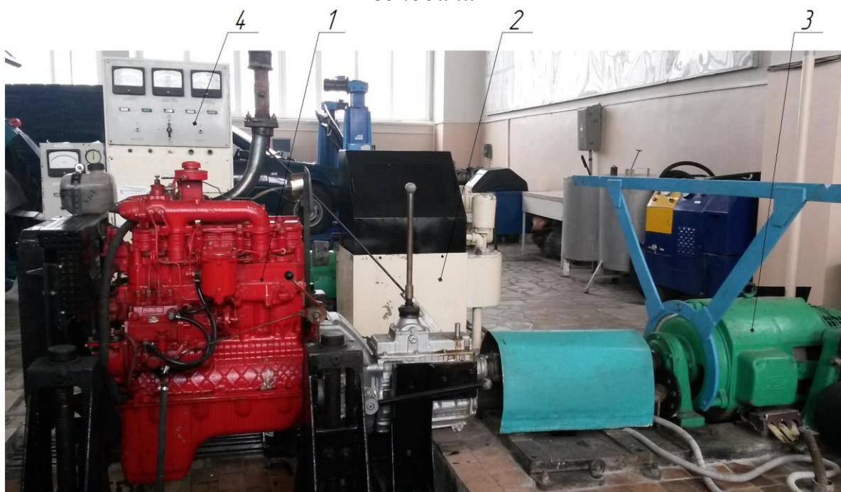
Рисунок 7 – Стенд для моторных испытаний: 1 – дизель Д-245.12; 2 – реостат жидкостный; 3 – динамометр электрический; 4 – пульт управления
