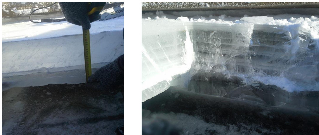
Рисунок 4.13 – Срез льда в бассейне при намораживании поверхностного слоя
