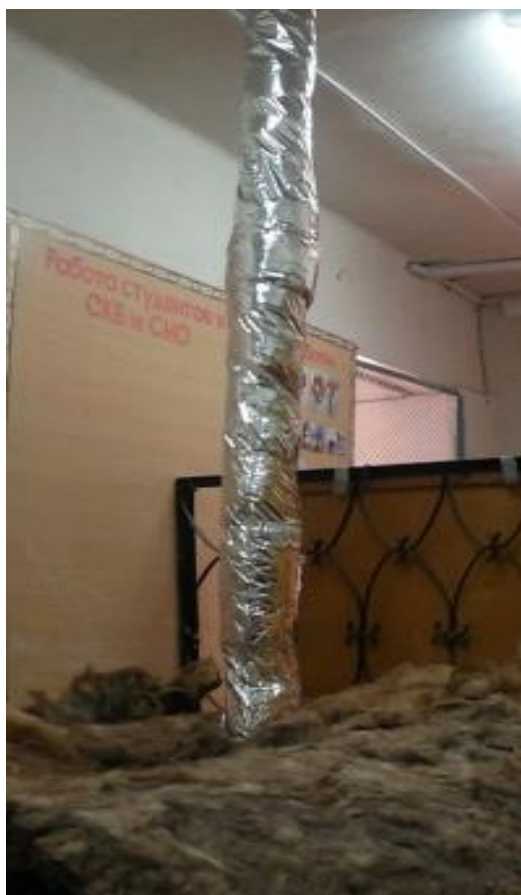
Рисунок 4.6 – Лабораторная установка по намораживанию льда вокруг испарителя термосифона
