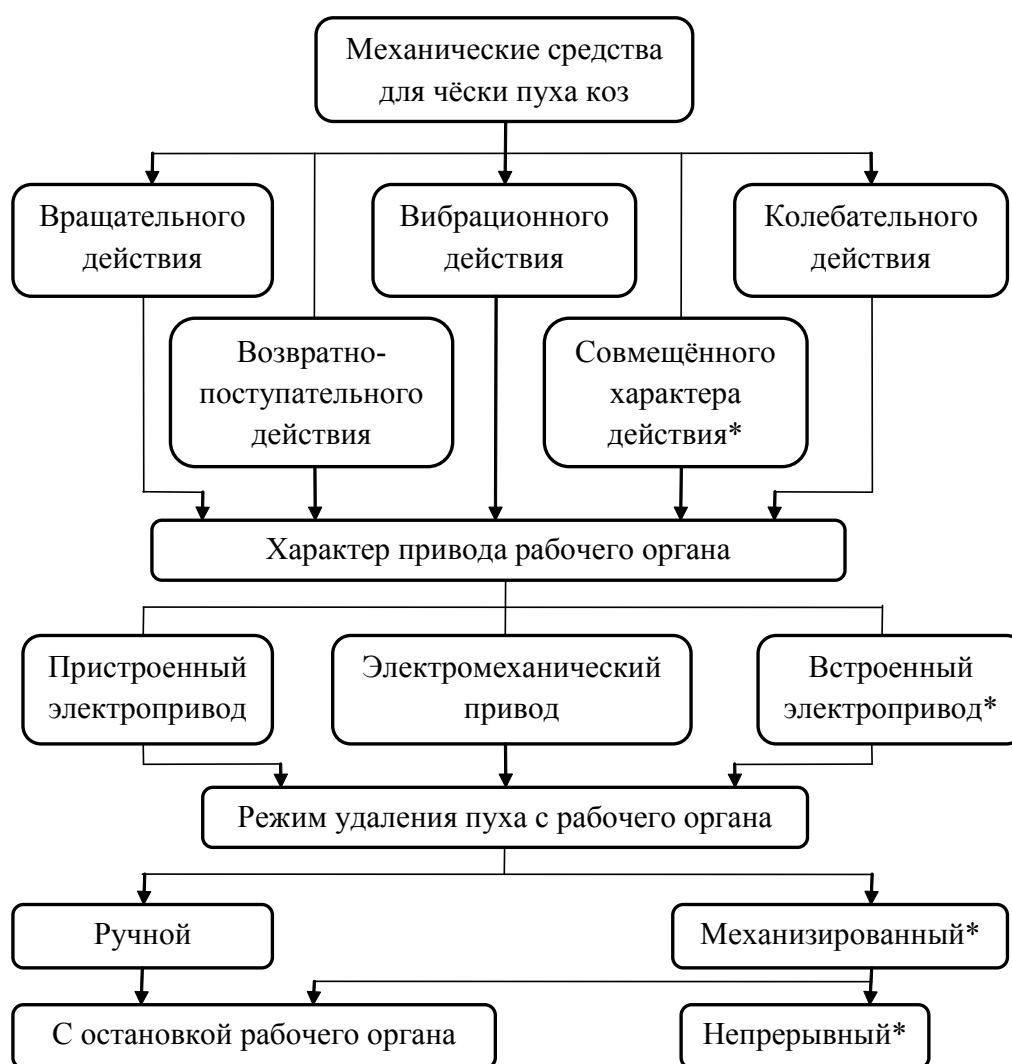
Рис. 2 – Классификация механических средств для чёски пуха коз
