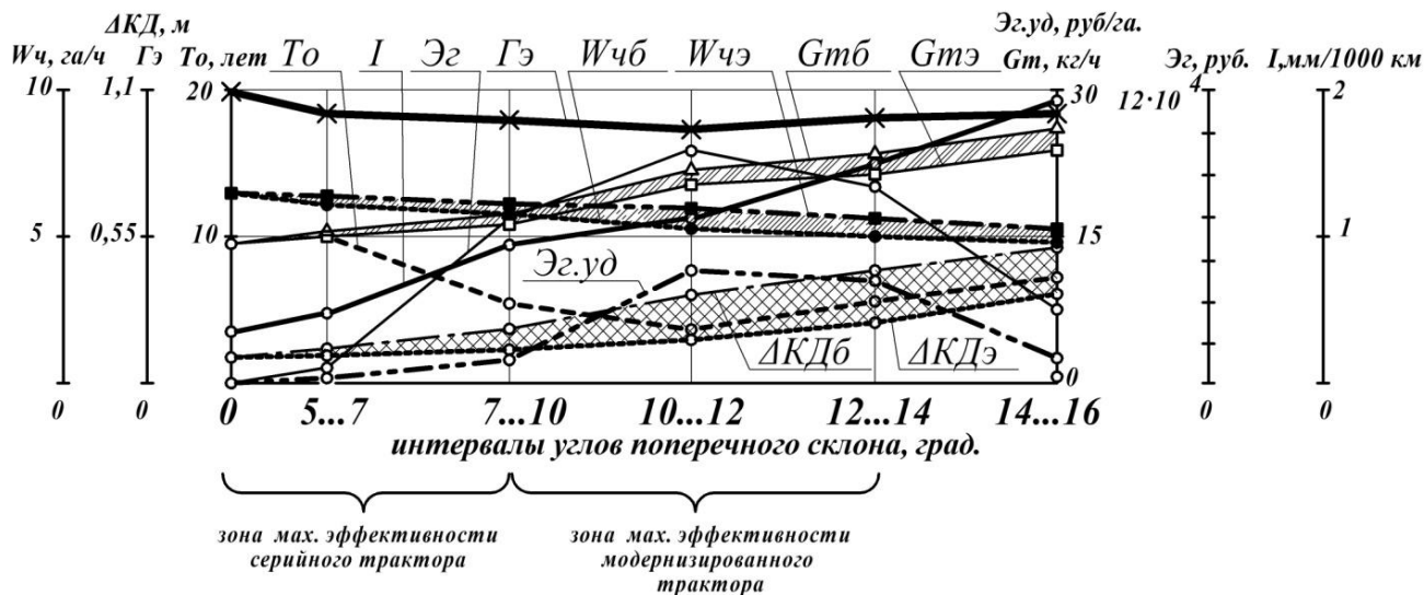
Рисунок 9 – Техничко-экономические показатели в функции угла наклона опорной поверхности: W_{чб} – часовая производительность серийного трактора, га/ч; W_{чэ} – часовая производительность экспериментального трактора, га/ч; I – интенсивность износа шин, мм/1000км; T_o – срок окупаемости, лет; G_{тб} и G_{тэ} – часовой расход топлива серийного и экспериментального тракторов соответственно, кг/ч; \Delta KДб и \Delta KДэ – увеличение коридора движения серийного и экспериментального трактора соответственно, м; \Gamma_{э} – граница эффективности; \text{Эг} – годовая экономия, руб.; \text{Эг уд.} – годовая экономия с одного гектара, руб./га.
