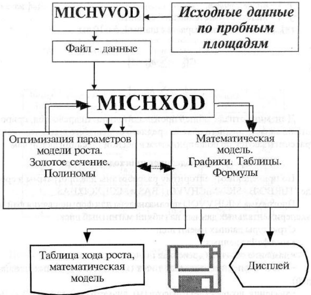
Рис. 5.2. Модельная структура программы MICHXOD
