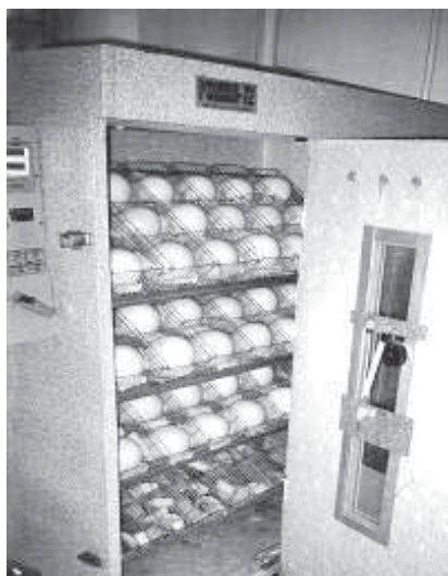
Рис. 1 – Инкубатор, реконструированный для яиц страуса
