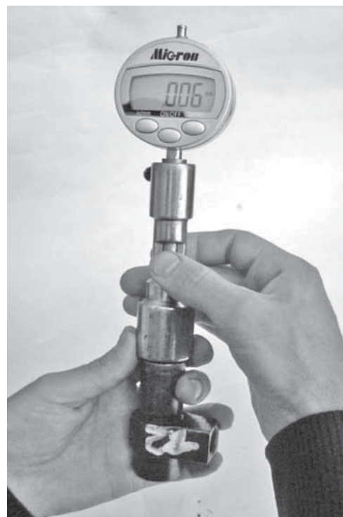
Рис. 2 – Приспособление для определения неперпендикулярности уплотнительного торца относительно геометрической оси корпуса форсунки
