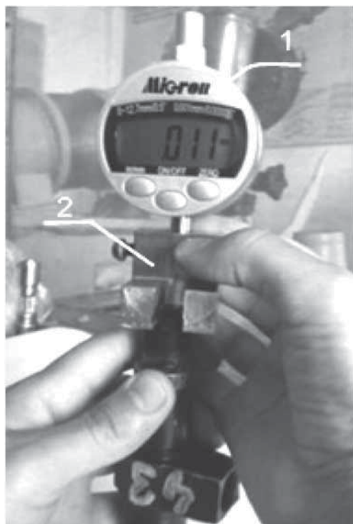
Рис. 1 – Приспособление для определения износа уплотнительного торца корпуса форсунки: 1 – отсчётный механизм; 2 – салазки
