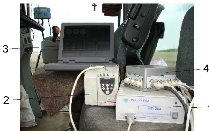
Рисунок 10 – Измерительная информационная система ИП 264 с частотным преобразователем TOSHIBA AC1, установленная в кабине трактора
