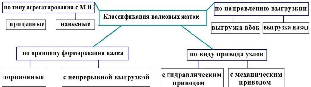
Рисунок 1.2 – Классификация жаток для отдельной уборки
