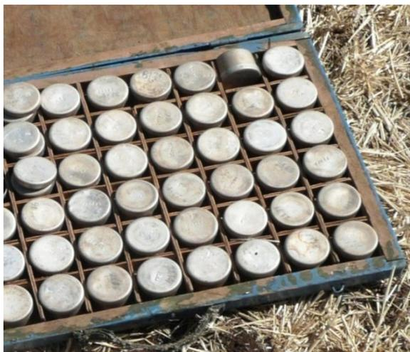
Рисунок 3.5 – Герметичные бюксы для сбора зерна при исследовании сушки в валках.
