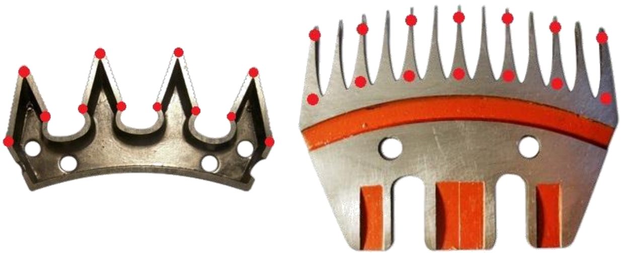
Рисунок 3.4 – Точки измерения твердости рабочих поверхностей ножа и гребенки
