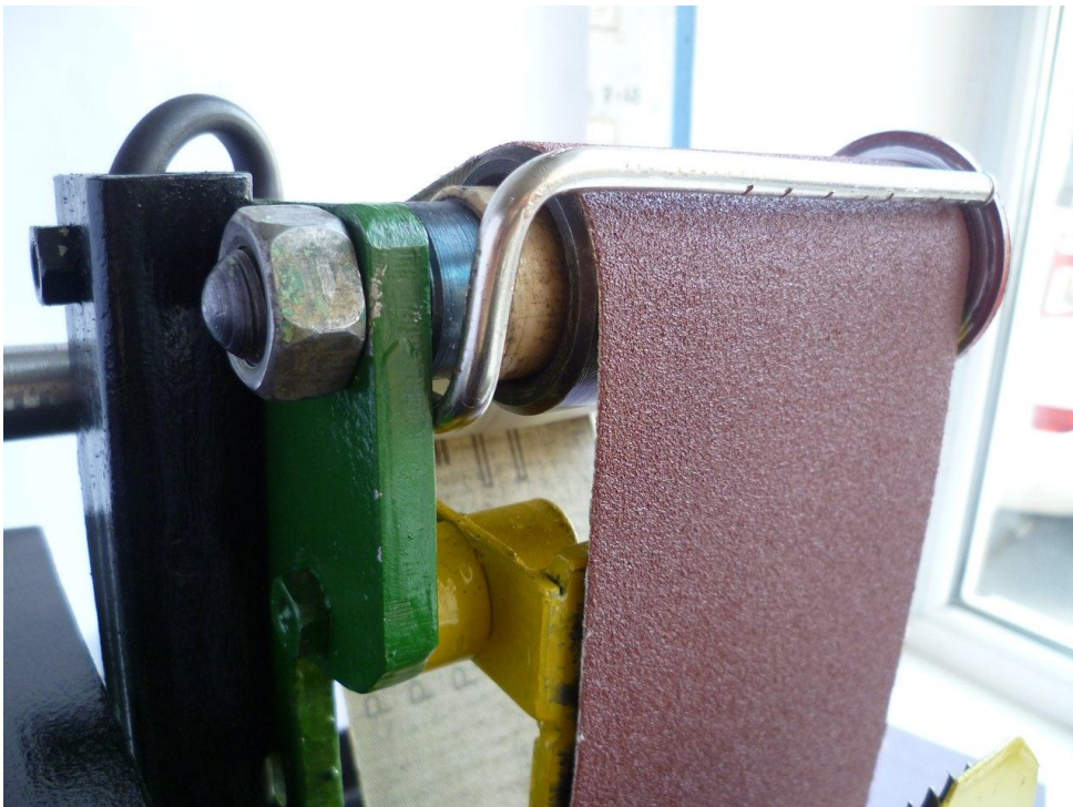
Рисунок 3.2 – Распределитель, подающий СОЖ в зону шлифования
