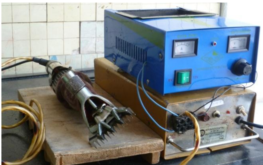
Рис 3.11 – Модификация стенда для ускоренного проведения испытаний качества заточки (Ю.А. Хлопко). Машинка МСУ-200.
