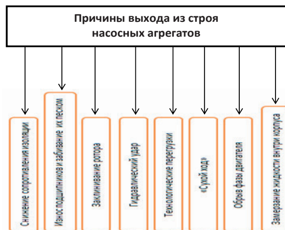
Рис. 2 – Причины выхода из строя насосных агрегатов
