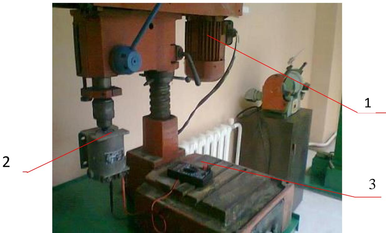
Рисунок 3.12 – Схема определения частоты вращения ротора: 1– электродвигатель; 2 – тахогенератор ТМГ-30-ПУЗ; 3 – вольтметр Ц4353.
