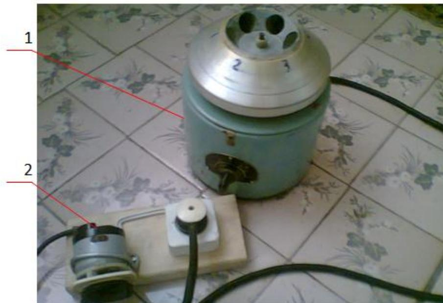
Рисунок 3.7 – Автоматический регулятор времени: 1 – центрифуга; 2 – реле времени.
