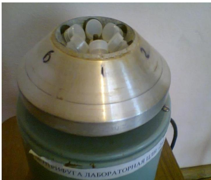
Рисунок 3.6 – Ротор центрифуги
