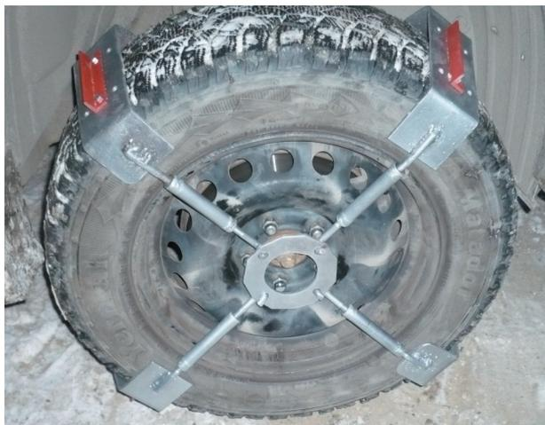
Рис. 4 – Общий вид устройства, смонтированного на ведущем колесе автомобиля
