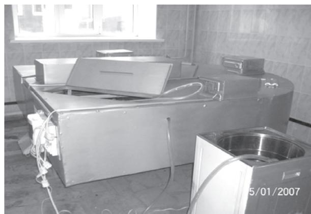
Рис. 2 – Установка для термообработки крови животных
