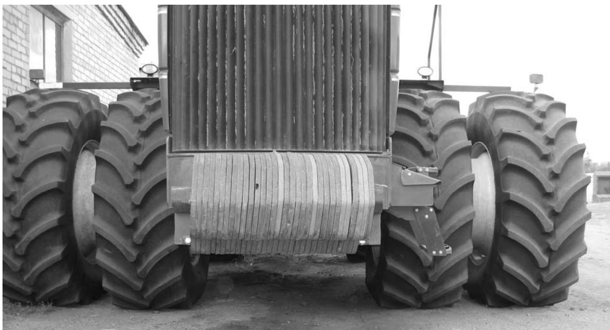
Рисунок 1.12 – Повышение устойчивости трактора путем установки сдвоенных колес
