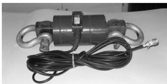
Рисунок 3.6 – Тензометрическое звено СТ-10А
