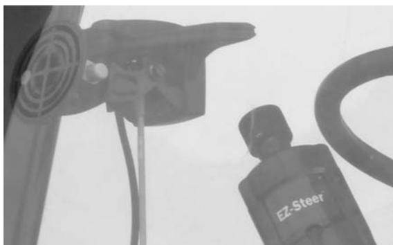
Рисунок 3.2 – контроллер EZ-Steer с технологией T2
