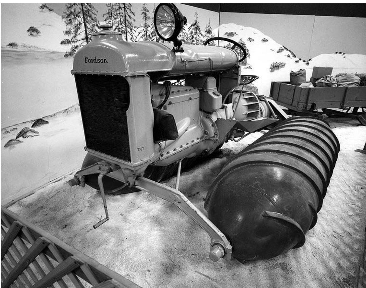
Рисунок 1.19 – Шнекороторный Fordson
