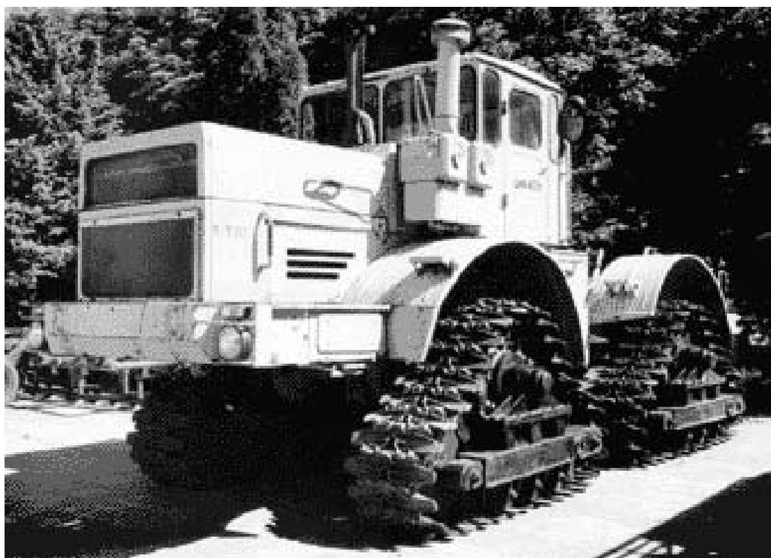
Рисунок 1.9 – Трактор К-701, оборудованный гусеничным ходом
