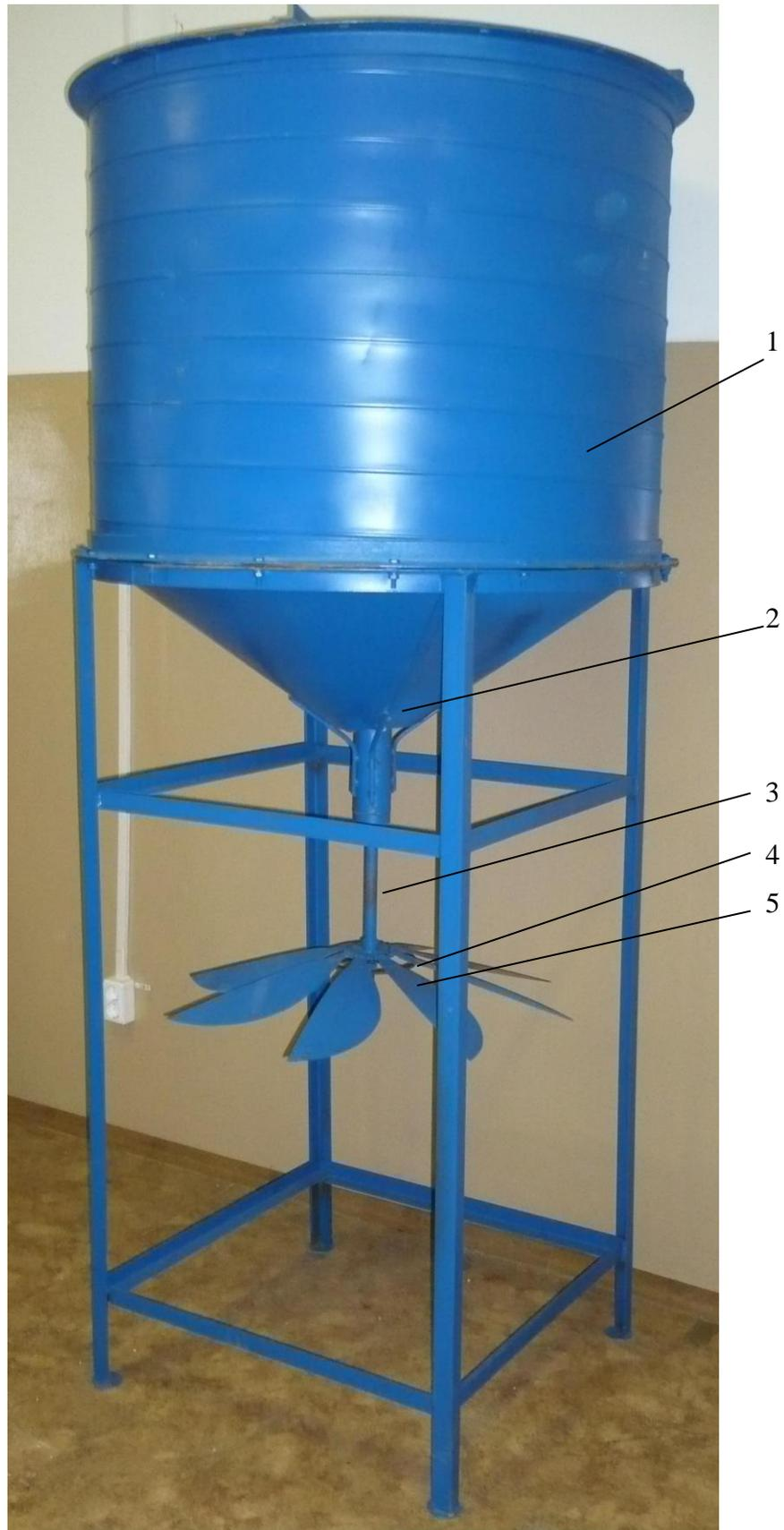
Рис. 3.1. Общий вид экспериментального загрузочно-распределительного устройства: 1- бункер; 2- воронка бункера; 3- ось распределительного устройства; 4- ограничитель; 5- лопасти
