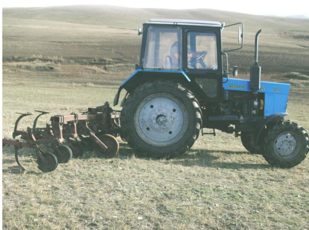
Рисунок 4.4 – Трактор МТ-82.1 с культиватором КРН-5,6В на склоне в процессе эксперимента
