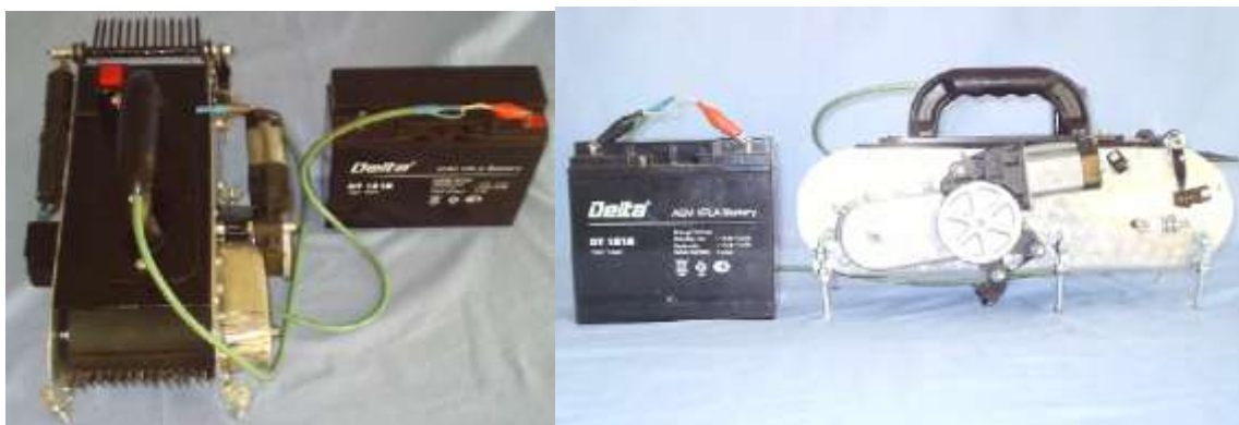
Рис. 3.8. Механическое ленточное устройство для вычесывания пуха коз.
