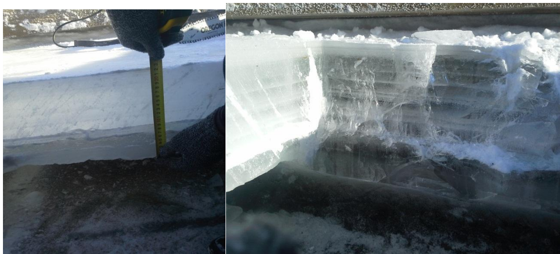
Рисунок 3.3 – Срез льда в бассейне при намораживании поверхностного слоя.
