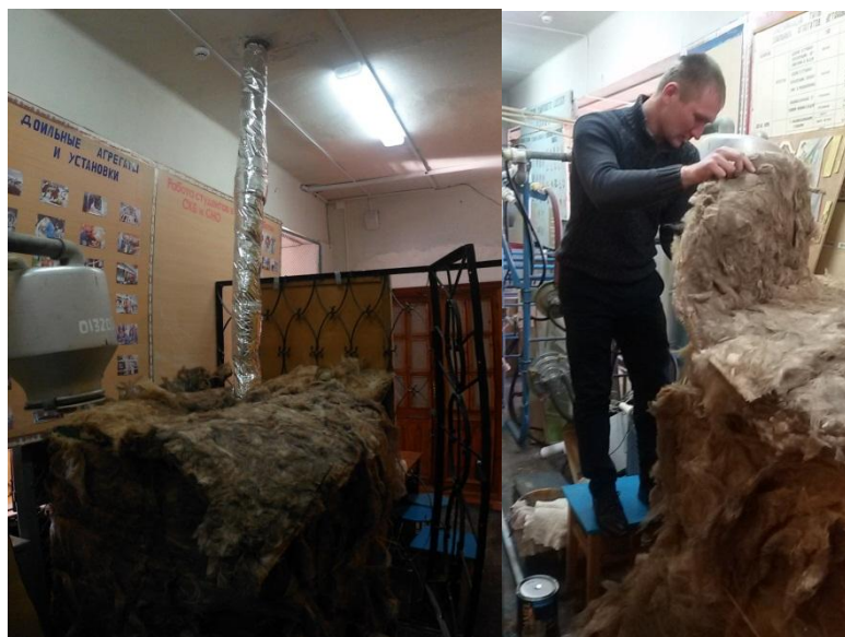
Рисунок 3.1 – Лабораторная установка по намораживанию льда вокруг испарителя термосифона.
