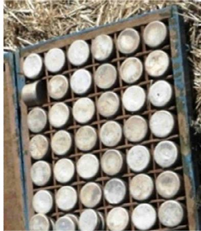
Рисунок 3.6 – Герметичные бюксы для исследования просыхания соломы в валке.
