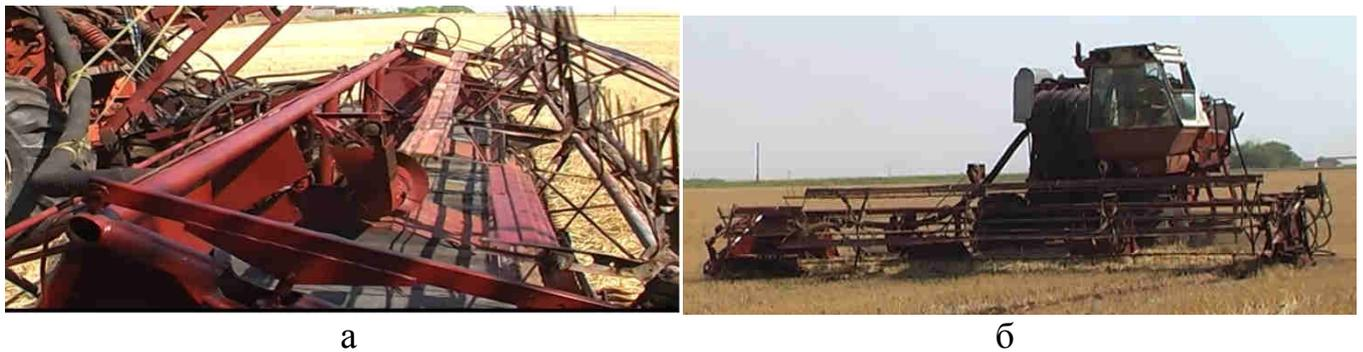
Рисунок 3.2 – Экспериментальный образец порционной жатки: а – вид сбоку, б – рабочий вид жатки.
