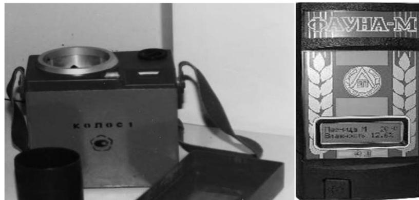
Рисунок 3.3 – Электронный экспресс-влажномер «Колос-1» и электронный влагомер «Фауна-М».
