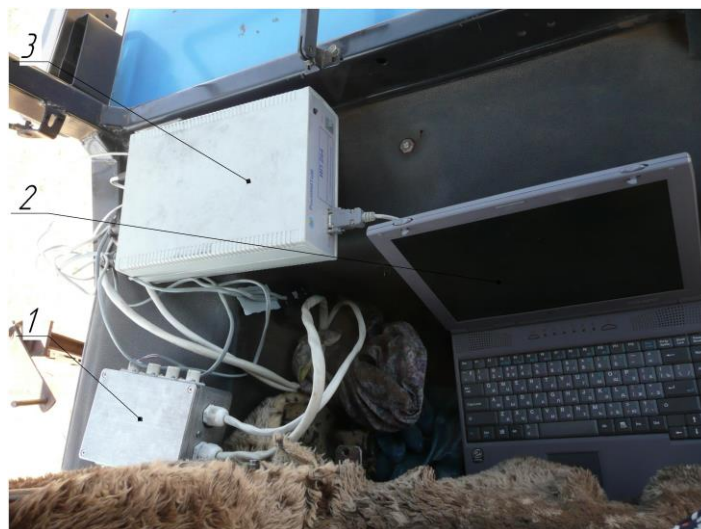
Рисунок 3.13 – Измерительная информационная система ИП 264, установленная в кабине трактора: 1 – распределительный короб РК-1; 2 – ноутбук; 3 – электронный блок
