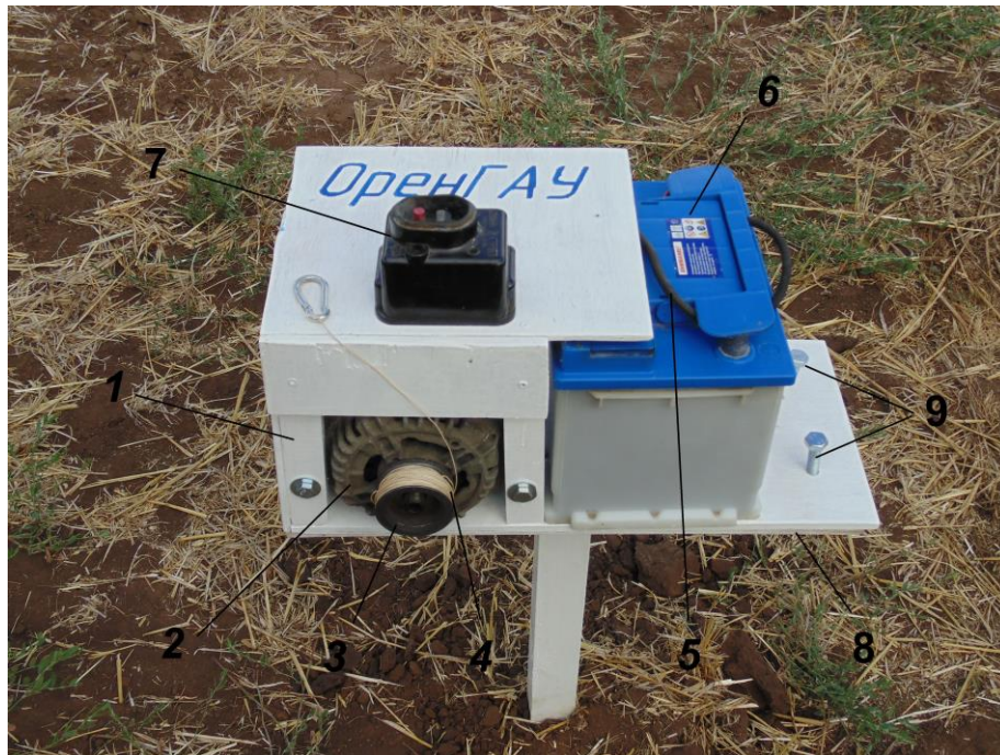
Рисунок 3.8 – Общий вид привода лабораторной установки: 1 – рама; 2 – электродвигатель; 3 – барабан; 4 – трос; 5 – кабель; 6 – источник электрического тока; 7 – электрический щиток; 8 – неподвижная платформа; 9 – болт
