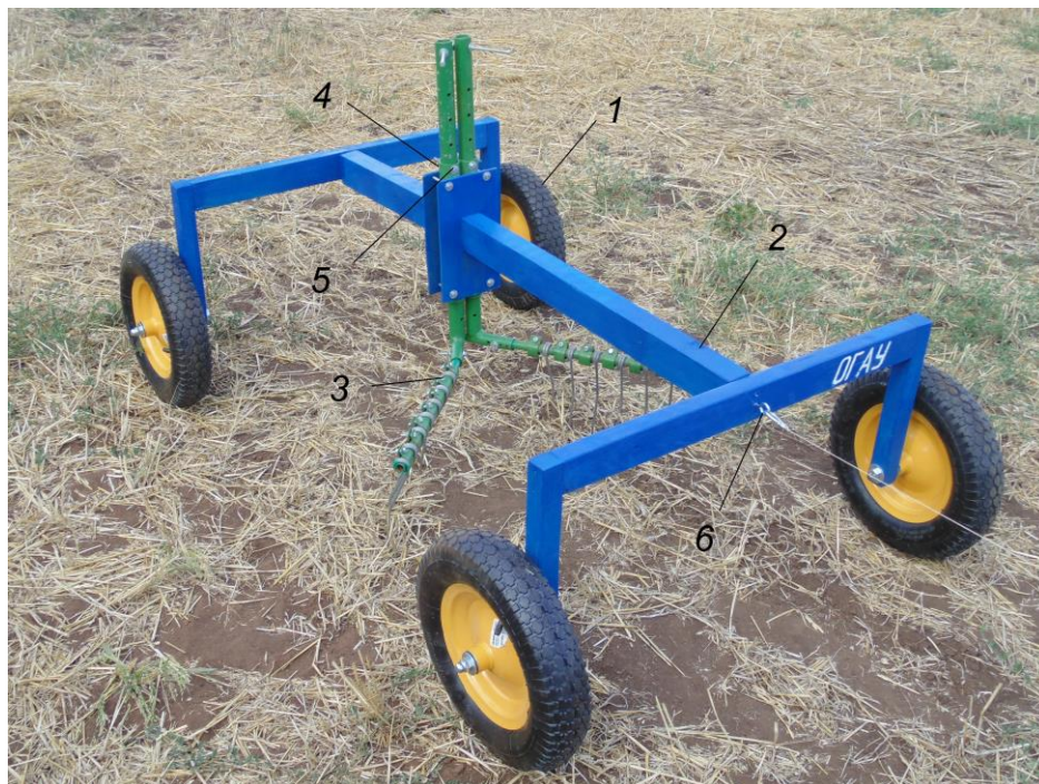
Рисунок 3.7 – Общий вид подвижной части лабораторной установки: 1 – опорное пневматическое колесо; 2 – рама; 3 – граблина; 4 – втулка; 5 – болт; 6 – буксировочное ушко
