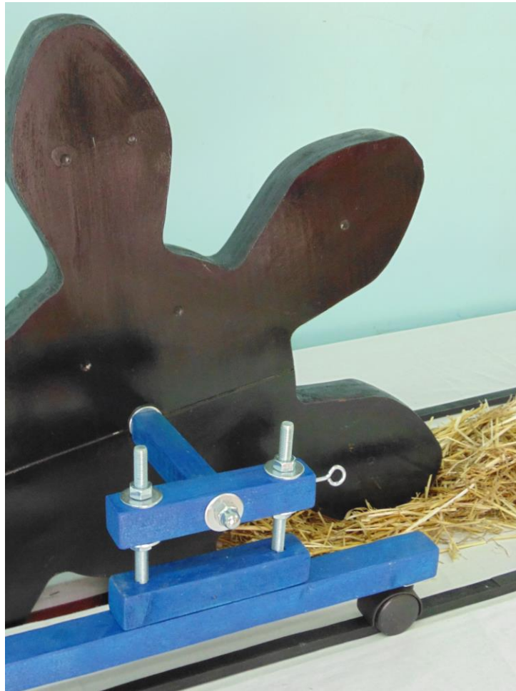
Рисунок 3.3 – Установка соломозаделывающего диска в исходное положение
