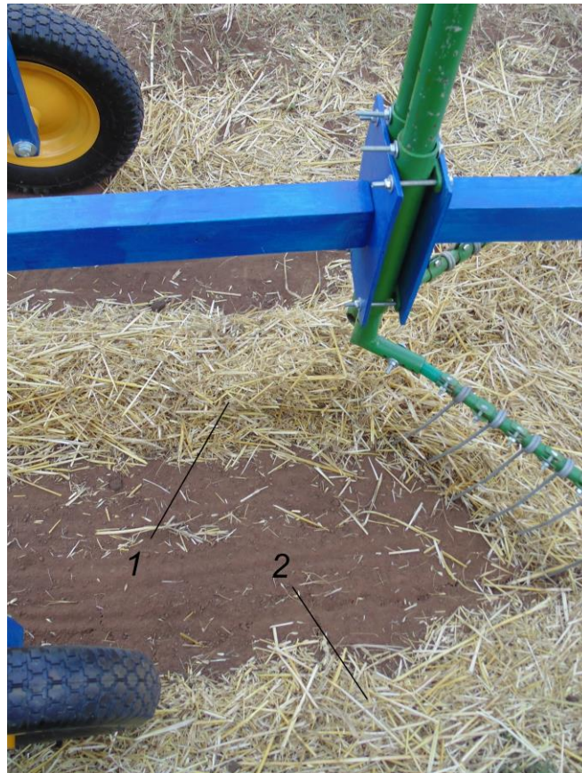
Рисунок 3.10 – Схема распределения соломистой массы после прохождения соломонаправителя: 1 – перемещенная; 2 – оставшаяся на месте
