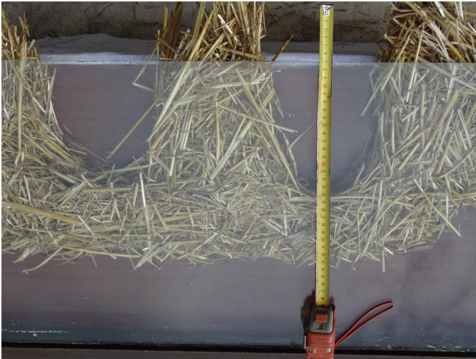
Рисунок 3.6 – Солома, заделанная в щель после прохождения диска
