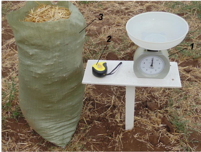
Рисунок 3.9 – Приборы и оборудование, использованные для определения оптимального угла фиксации граблин соломонаправителя: 1 – весы; 2 – рулетка; 3 – мешок
