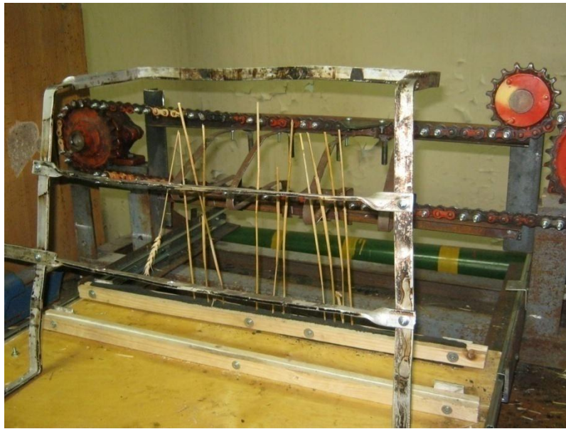
Рисунок 4.11 – Лабораторная установка режущего аппарата с двойным срезом стеблей
