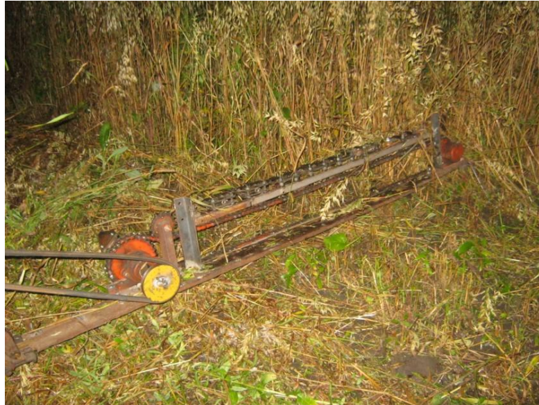
Рисунок 4.13 – Опытный образец режущего аппарата с двойным срезом стеблей
