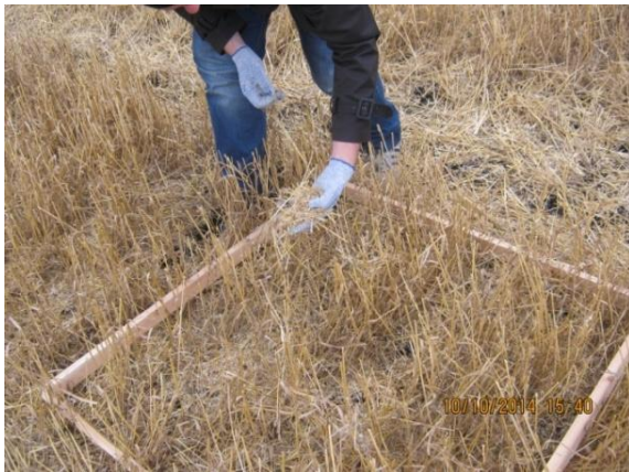
а) взятие проб на потери зерна колосом за жаткой комбайна
