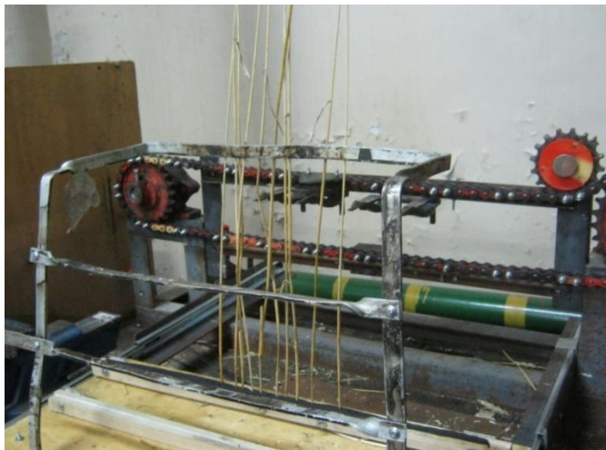
Рисунок 3.7 – Лабораторная установка для изучения процесса двойного среза стеблей зерновых культур
