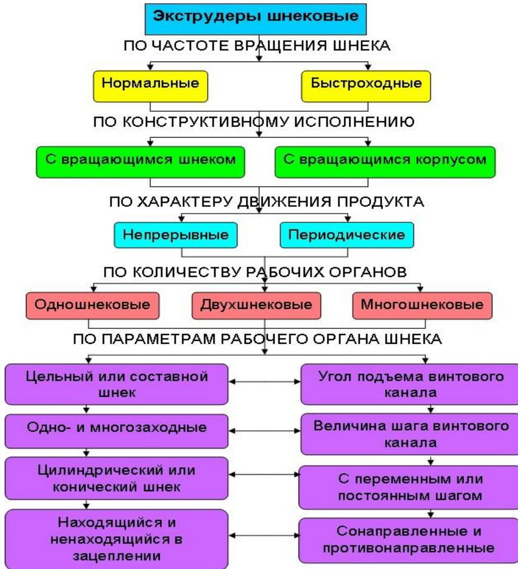
Рисунок 1.2 – Классификация шнековых пресс-экструдеров
