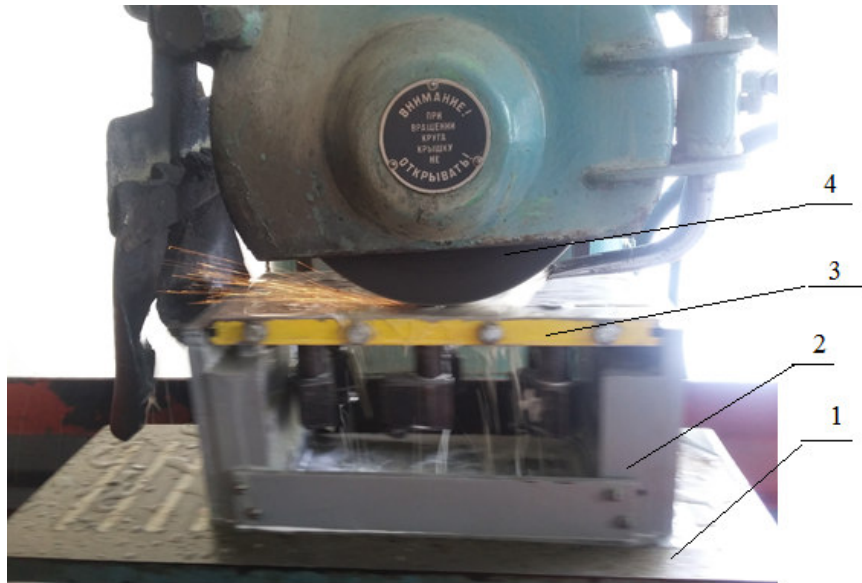
Рисунок 3.6 - Шлифование УТКФ на станке 3Г71: 1 – магнитный стол; 2 – станина; 3 - плита для шлифования и доводки; 4 – абразивный круг
