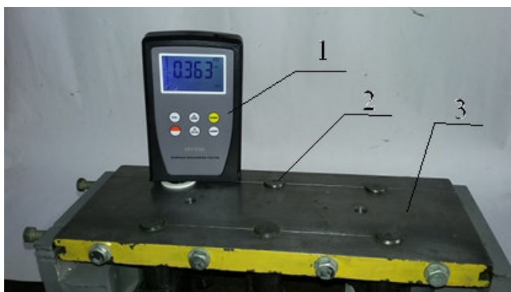
Рисунок 3.9 – Измерение шероховатости уплотнительного торца корпуса форсунок;
