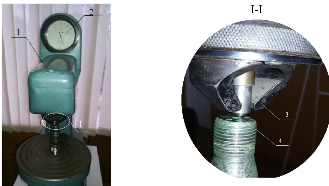
Рисунок 3.10 – измерения твердости с использованием твердомера ТК – 2; 1- твердомер, 2 - индикаторный указатель твердости, 3 – конус (индентор), 4 – уплотнительный торец корпуса форсунок
