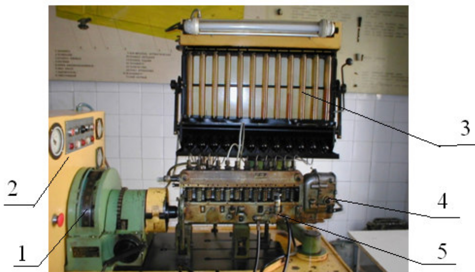
Рисунок 3.12 Стенд для испытания дизельной топливной аппаратуры КИ-15711М-01-ГОСНИТИ.
