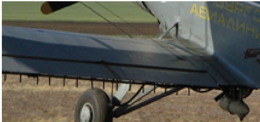
Рисунок 3.1 — Размещение распылительного устройства на крыле СЛА
