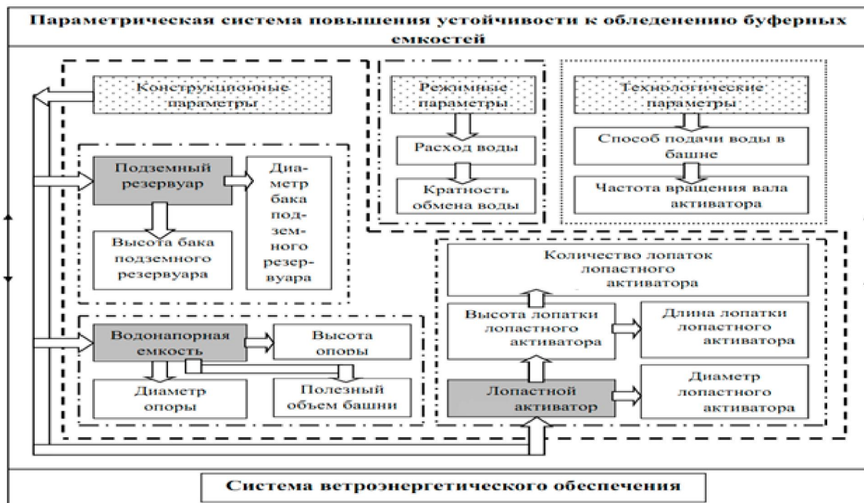
Рисунок 2.3 – Параметрическая система повышения устойчивости к обледенению буферных емкостей
