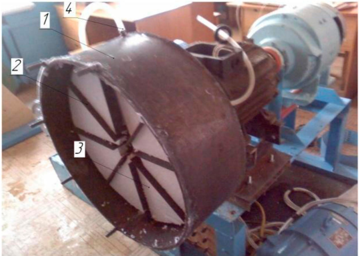
Рисунок 3.28 – Внешний вид лабораторной установки (вид со стороны активатора, крышка открыта): 1 – корпус, 2 – лопасти, 3 – лопастной активатор, 4 – вентиль
