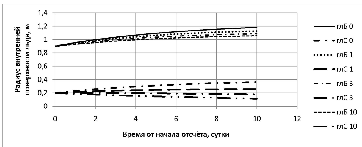
Рисунок 3.11 – Зависимость радиусов внутренних поверхностей льда в баке и стойке башни от времени обледенения при V=(0; 1; 3; 10) м/с; r_{\text{ЛЮБ}}=0,9 м; r_{\text{ЛЮС}}=0,2 м; Q=2 \text{ м}^3/\text{час} ; T=-30^\circ\text{C}
