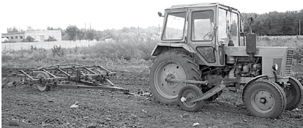
Рис. 1 – Испытуемый агрегат в составе трактора МТЗ-80 и культиватора КПС-4А с измерительным оборудованием
